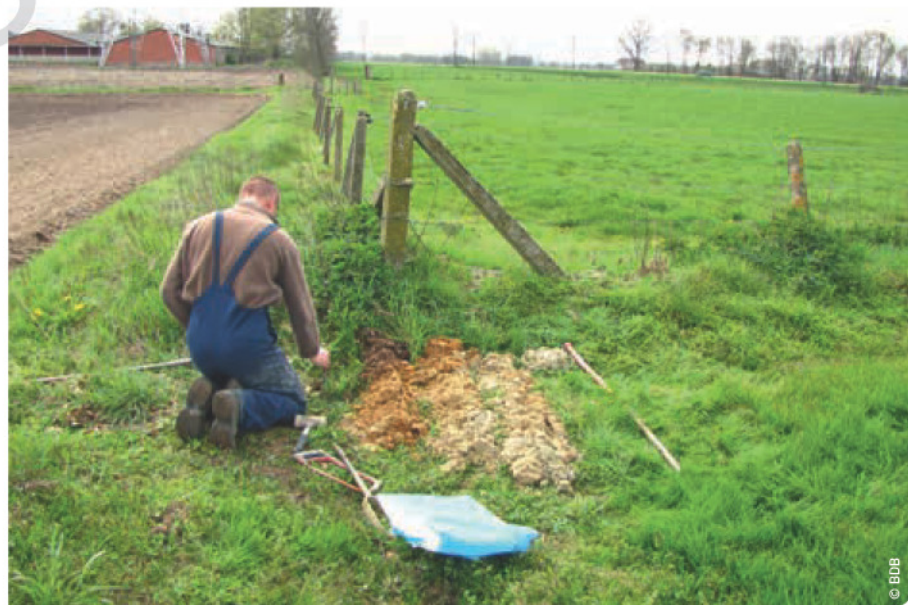
Vorbereiding voor bemonstering van het grondwater in een peilbuis.
