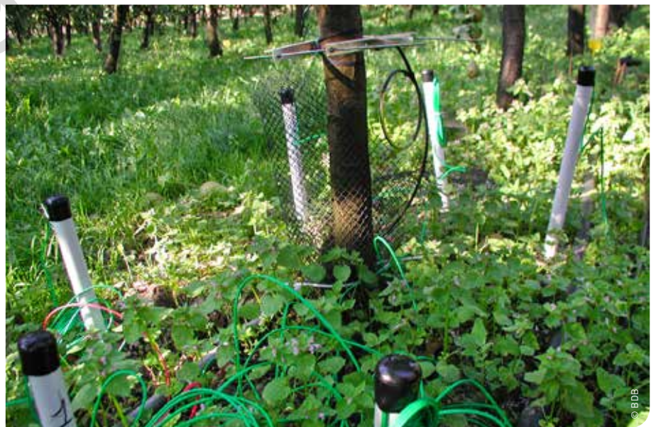
Om inzicht te krijgen in de manier waarop men bodemsensoren het beste opstelt, werd met Watermarkbodemsensoren de waterspanning in de bodem rondom de fruitboom gemeten.
